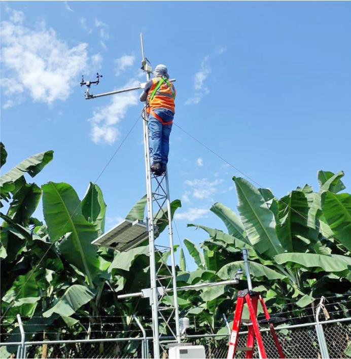
Las estaciones climáticas recogen, almacenan y transmiten datos meteorológicos continuamente. Es por ello, que el pasado mes de agosto se llevó a cabo el mantenimiento de nuestras estaciones, con el objetivo de garantizar que los sensores meteorológicos se hallen operando bajo buenas condiciones, prolongando el tiempo de disponibilidad y de buen funcionamiento del equipo.
