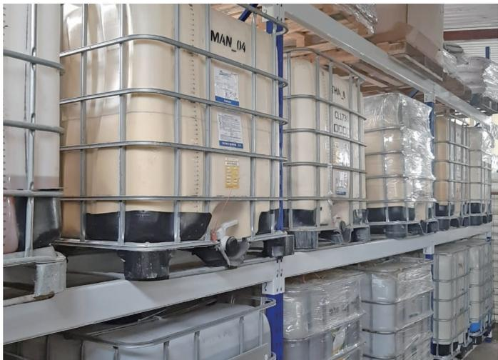
Empacadora 2 realizó en el mes de junio la adquisición de un **rack selectivo S-100 de tres módulos H-400 con tres niveles.**
